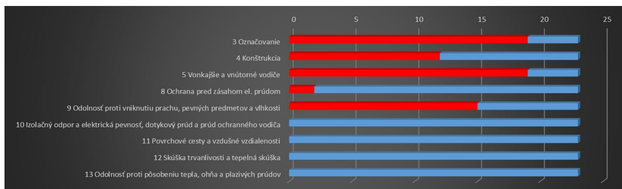
Graf č. 2 – Výsledky skúšok podľa harmonizovanej normy STN EN 60598-1 v spojení s STN EN 60598-2-20
